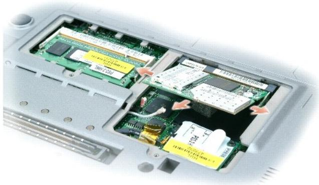
➔ **AVISO:** Os conectores têm formatos especiais para garantir a inserção correta. Se sentir resistência, verifique os conectores e realinhe a placa.
